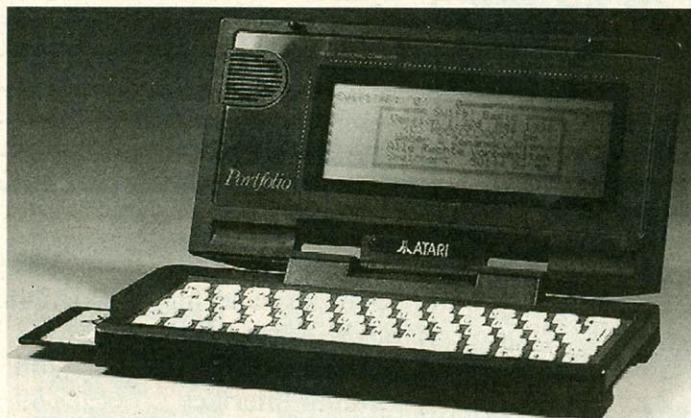
Die ROM-Karte mit »Swift! Basic« wird seitlich ins Kartenlaufwerk geschoben
