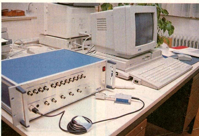
Ein EPC-9 mit Mega-STE und Simulatorschaltung
