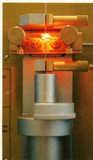
Eine Heizwendel erhitzt die feine Glaspipette
